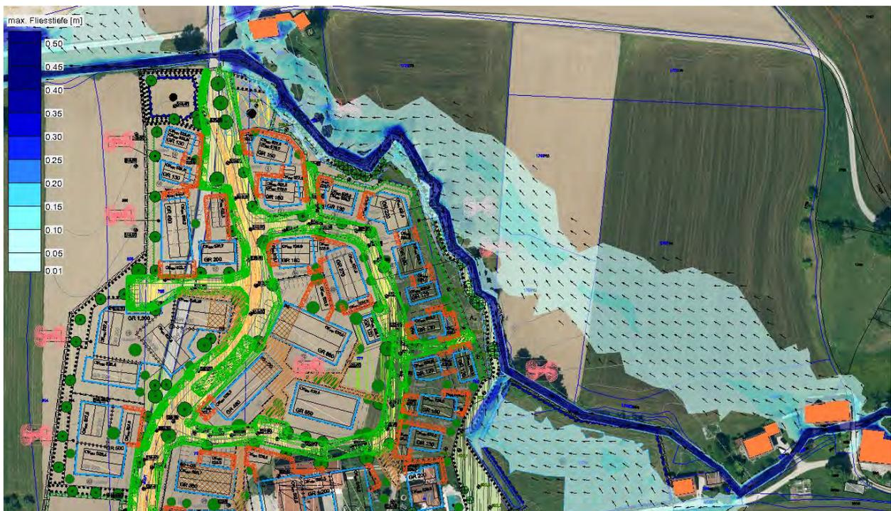
Abbildung 5.10: Detailausschnitt Maximale Fließtiefen und Strömungsrichtungen; Planungszustand; HQ<sub>100</sub>
