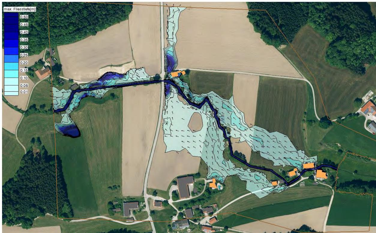
Abbildung 5.3: Maximale Fließtiefen und Strömungsrichtungen; Ist-Zustand; HQ<sub>100</sub>
