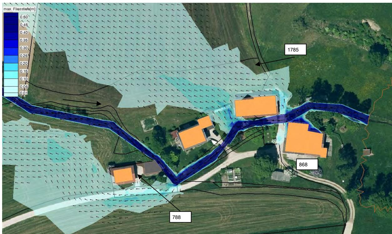
Abbildung 5.4: Detailausschnitt Ausuferung, maximale Fließtiefen und Strömungsrichtungen; Ist-Zustand; HQ<sub>100</sub>
