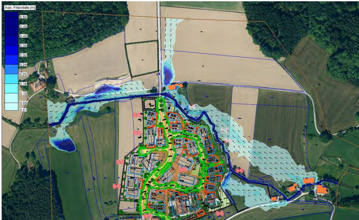
Abbildung 5.9: Maximale Fließtiefen und Strömungsrichtungen; Planungszustand; HQ<sub>100</sub>
