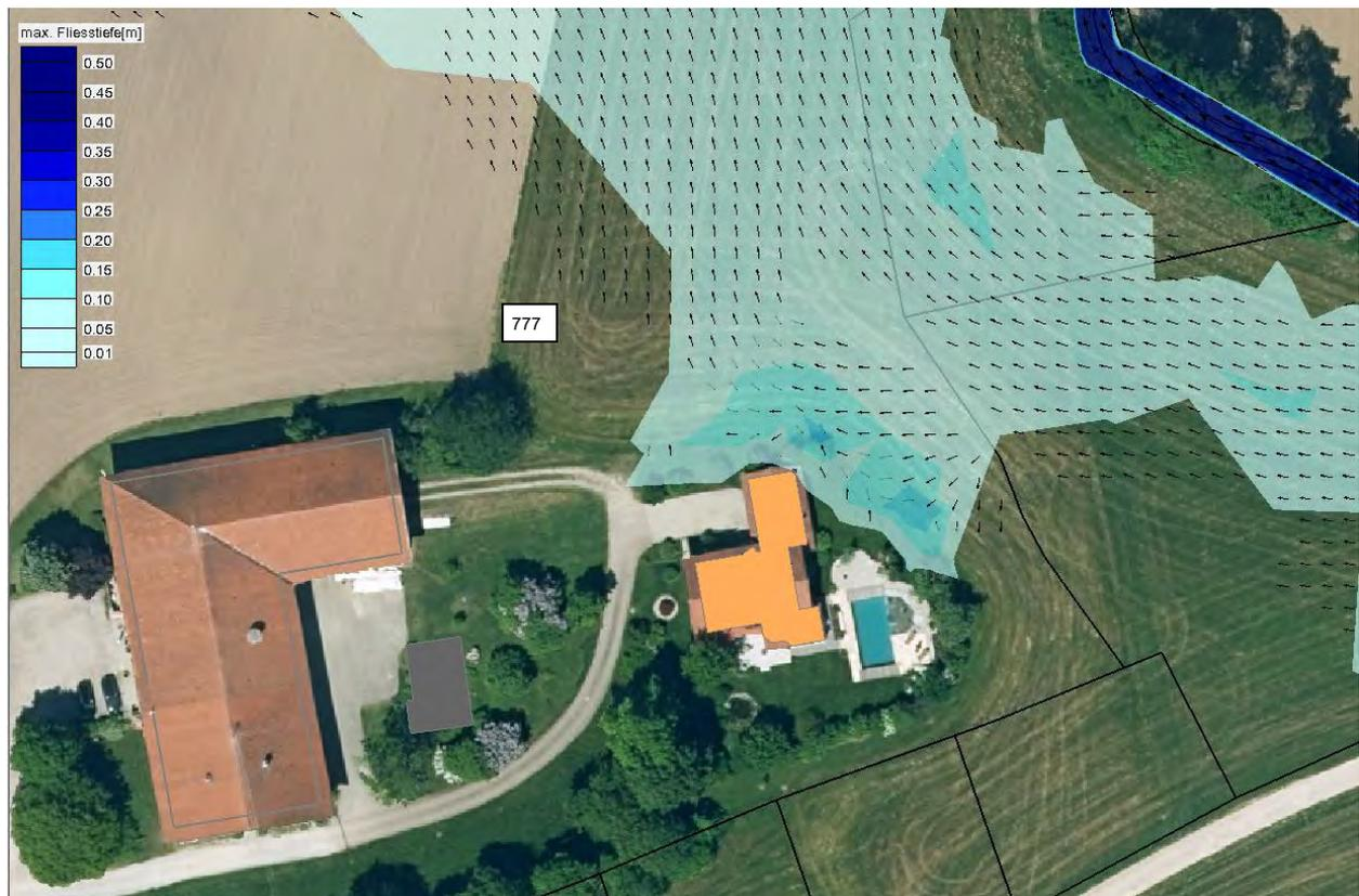
Abbildung 5.6: Detailausschnitt Einzelanwesen Flst.-Nr. 777, maximale Fließtiefen und Strömungsrichtungen; Ist-Zustand;  $HQ_{100}$
