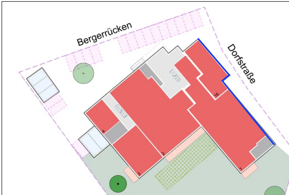
Abbildung 8: Grundriss mit Kennzeichnung der Bereiche und der Fassaden, an denen Schallschutzmaßnahmen erforderlich sind
